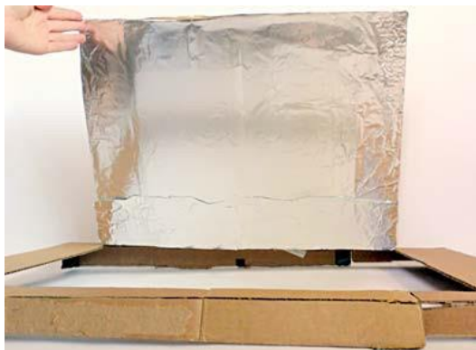
18-rasm. Alyuminiy folga yopishtirilgan pech qopqog'i.
